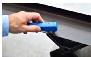
Test d'adhérence par essai de quadrillage selon la norme NF EN ISO 2409
