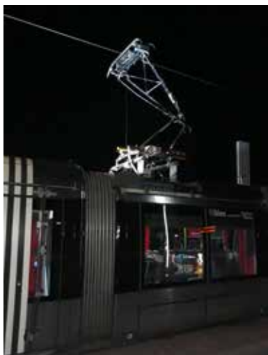
Rame équipée du système de mesure de LAC en dynamique
